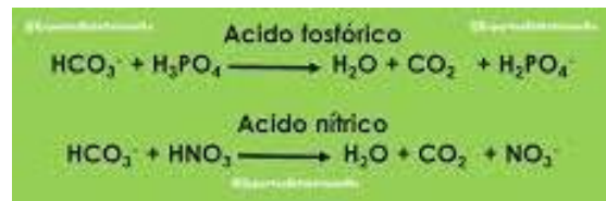
Imagen 3. Reacciones del bicarbonato al adicionar ácido a la solución fertilizante.
