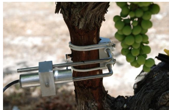
Ilustración 1. Dendrómetro instalado en el tronco de viña.
