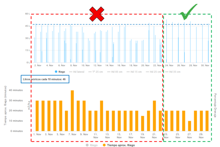
Figura 3. Comportamiento de la uniformidad del riego al aplicar pulsos por debajo del mínimo pulso efectivo.
