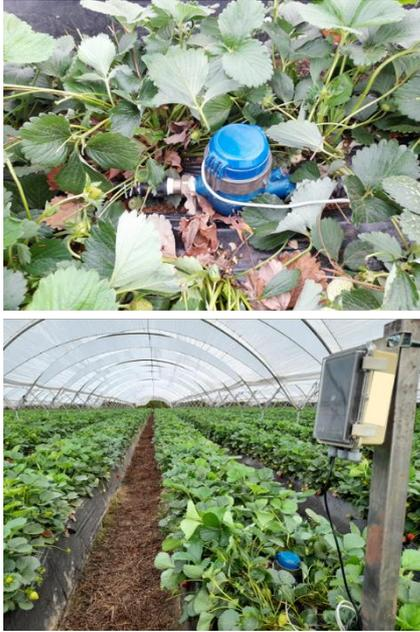
**Ilustración 3.** Instalación de caudalímetro para el control de las descargas en cultivo de fresa.
