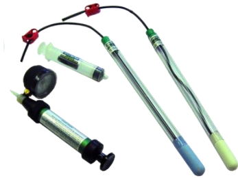
Figura 4. Lisímetros, equipo de vacío y extracción de solución de suelo.
